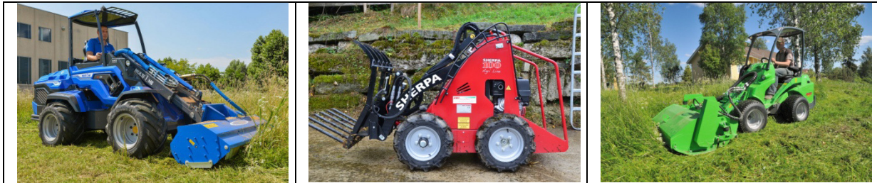
Fahrerposition links/rechts: Fahrer sitzt auf dem «Vorderwagen». Mitte: stehend
