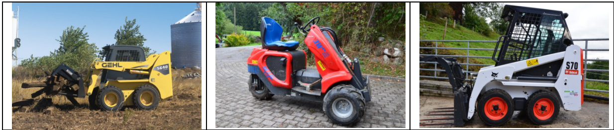
Lenkart links/rechts: Skidder bzw. «Panzerlenkung». Mitte: Dreirad-Hecklenkung
